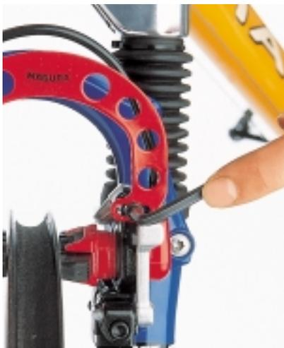
**5** Auch das Anbringen eines **BRAKEBOOSTERS** hilft gegen Quietschen und verbessert obendrein den Druckpunkt je nach Gabel und Rahmen mehr oder minder deutlich. Montage: Auf der Schnellspannerseite der Bremse die Klemmschraube herausdrehen. Der Booster wird mit der Schraube durch das Langloch auf den Bremssattel geschraubt (4 Nm Anzugsmoment). Auf der anderen Seite muß der Booster mit einem der beiden Rundlöcher nur über die Klemmschraube geschoben werden.
