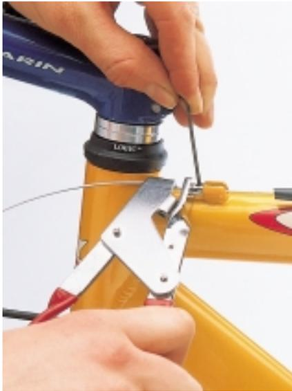
**1** Mit dem **LEITUNGSBEFESTIGUNGSKIT** sitzt der Ölschlauch sauber und sicher am Rad. So geht's: festen Nippel durch den Kabelstopper ziehen. Schrumpfschlauch mit 1 cm Überlänge darüber, Seil spannen und mit Schraubnippel festklemmen. Überflüssigen Seilrest abwickeln.
