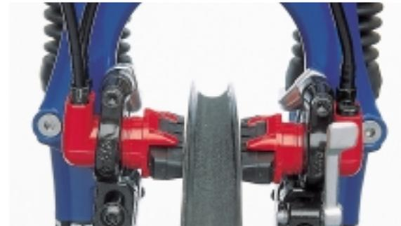
**4** Auch Magura-Bremsen können **QUIETSCHEN**. Das beste Gegenmittel lautet auch bei dieser Bremse: Beläge schräg anstellen. Dazu muß die 5er Inbusschraube der Bremssattelklemmung gelöst werden. Anschließend den Belag in die gewünschte Position drehen, Inbus wieder festziehen. Als Anzugsmoment reichen 4 Nm, den Inbusschlüssel daher an der kurzen Seite halten.
